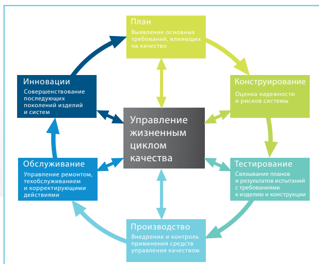
Рис. 2. Процесс управления жизненным циклом качества (QLM) объединяет в себе посредством единой платформы баз данных действия по обеспечению качества, выполняемые на любом из этапов жизненного цикла изделия.
